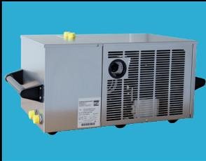
Unterthekenkühler mit 2 Getränkeleitungen, stabilen Tragegriffen und Temperaturregler. Biereingang stirnseitig, Bierausgang oben hinten. Kompaktes Edelstahlgehäuse. Niedrige Bauhöhe zum Einbau in z.B. Ausschankfahrzeuge. Der Gehäusedeckel ist geteilt. Das Gehäuseteil über den Servicekomponenten ist separat abnehmbar. Somit können die Getränkeschläuche, wenn gewünscht, angeschlossen bleiben. Die hohe Ausschankkapazität sichert auch einem großen Besucheraufkommen jederzeit frisches, kühles Bier!
